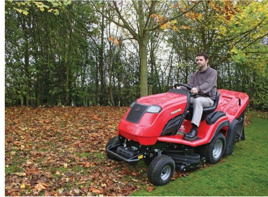
Zikzak lastikler kaygan zeminlerde ve çamurda ekstra tutuş sağlar.
