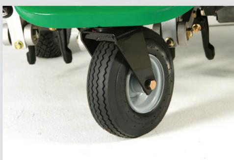
Farklı ön lastik dizaynı, makineye sıfır dönüşe yakın manevra kabiliyeti verir.
